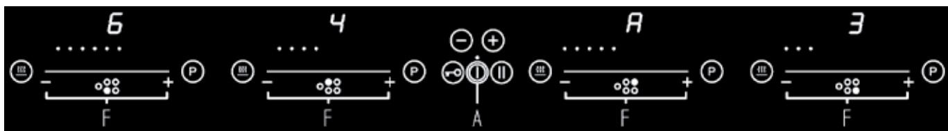
A scadenza del tempo indicato nella tabella, la funzione viene disinserita e la “A” si spegne. Il sistema di cottura automatica può essere disinserito in qualsiasi momento modificando il livello di potenza della cottura.
