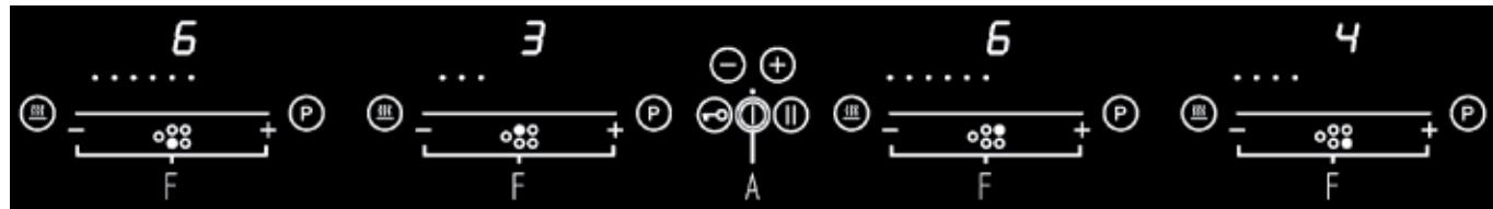
Se viene premuto, per almeno 3 secondi, un punto preciso del cursore, si attiva il sistema di cottura automatico (vedere il capitolo riscaldamento veloce automatico)
