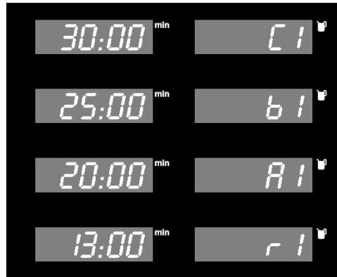
Drücken Sie PT1 und drehen Sie um den von ihnen gewünschte Spezial Funktion Programm aus zu wählen, die Programmanzeige blinkt.
