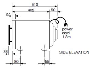
NB total depth door open 968mm nett depth door open 433mm
