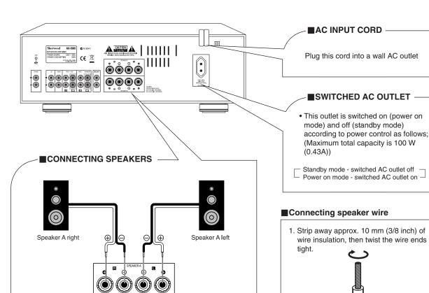
CAUTION SPEAKER IMPEDANCE A,B - 8Ω MIN / SPEAKERS A+B -16Ω MIN / SPEAKERS
